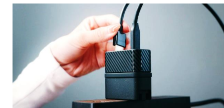
Aquarius TD – универсальная док-станция совмещенная с блоком питания (опция)
